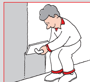
Slätspackling görs med bred stålspackel.
